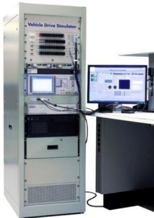
Obrázek 9.1. Simulátor jízdy vozidla firmy DGE je založen na NI hardwaru a softwaru.
