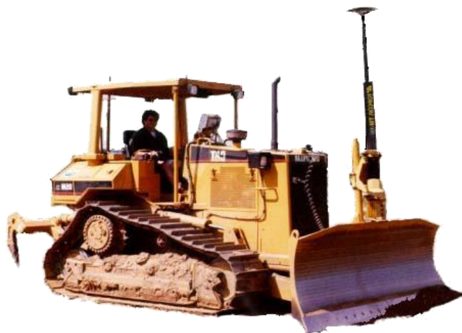
Obrázek 3.8 Buldozer s nainstalovaným řídicím systémem MC 2
