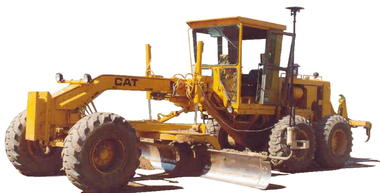
Obrázek 3.7 3D GPS systém nainstalovaný na graderu
