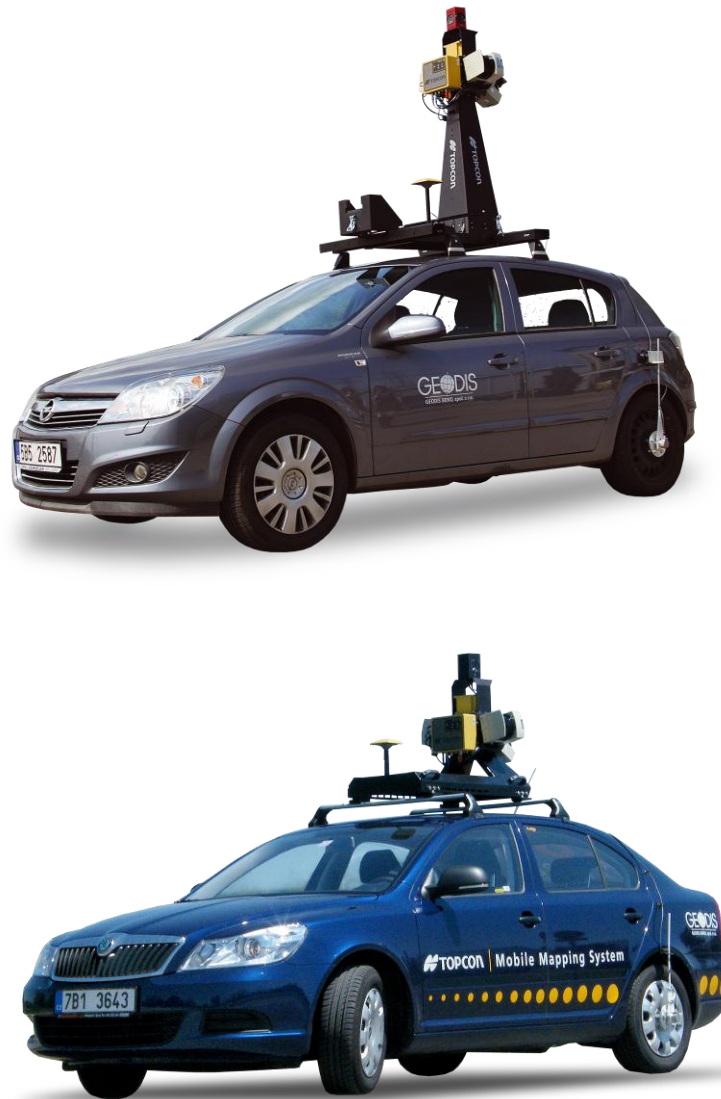
Obrázek 4.1 Základní konfigurace mobilního mapovacího systému IP-S2
